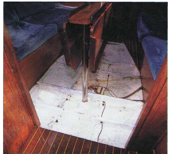
Dans les fonds, les varangues sont stratifiées. L'Attalia n'a qu'un petit contremoule, dans le cabinet de toilette.
